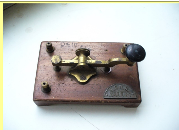
Телеграфный ключ коллективной радиостанции eu4KAT
